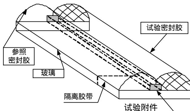
图 A.3 附件相容性试验的试件形式
