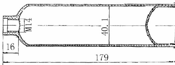
图 1 挤出性试验用挤胶筒
