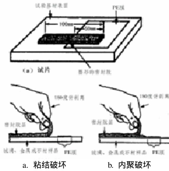
图 D.2 非破坏手拉剥离试验
