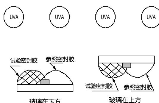
图 A.1 光照试件的放置
